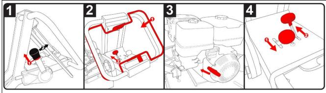
STEP 1: LIFT RING UP THEN MOVE BRAKE LEVER TOWARD OPERATOR. STEP 2: PUSH
