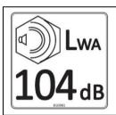
MAXIMUM SOUND POWER LEVEL (LWA). EAR PROTECTION MUST BE WORN WHEN OPERATING THE MACHINE.
